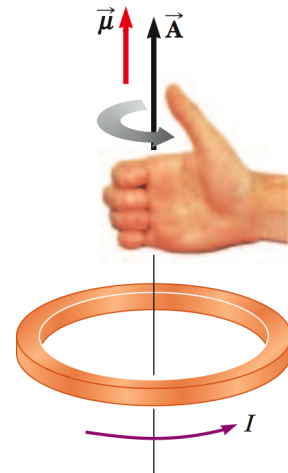
Figura 6.9: Momento magnético de uma espira de área A e corrente i . (Serway)
