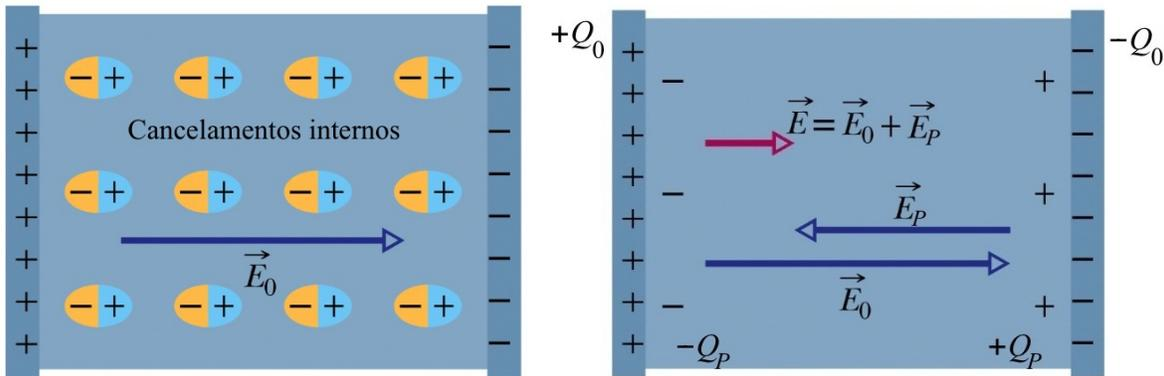
Figura 4.6: Capacitor de placas paralelas com um dielétrico. Antes da introdução do dielétrico, há um campo  $\vec{E}_0$  entre as placas. Introduzindo o dielétrico, o momento de dipolo de suas moléculas se alinha com  $\vec{E}_0$ . As cargas internas se cancelam, mas forma-se uma carga de polarização  $Q_P$  que cria um campo de polarização  $\vec{E}_P$  como "outro capacitor", oposto a  $\vec{E}_0$ . O campo final  $\vec{E}$  é a soma de  $\vec{E}_0$  e  $\vec{E}_P$ . (Halliday)
