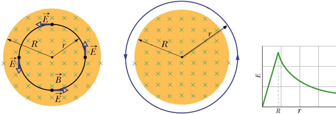
Figura 8.6: Tubo de raio  $R$  com campo magnético  $B$  que varia no tempo. Anéis de cobre são colocados dentro e fora do tubo, e têm um campo  $E$  circulante. O campo induzido cresce dentro do tubo e decai fora dele. (Halliday)
