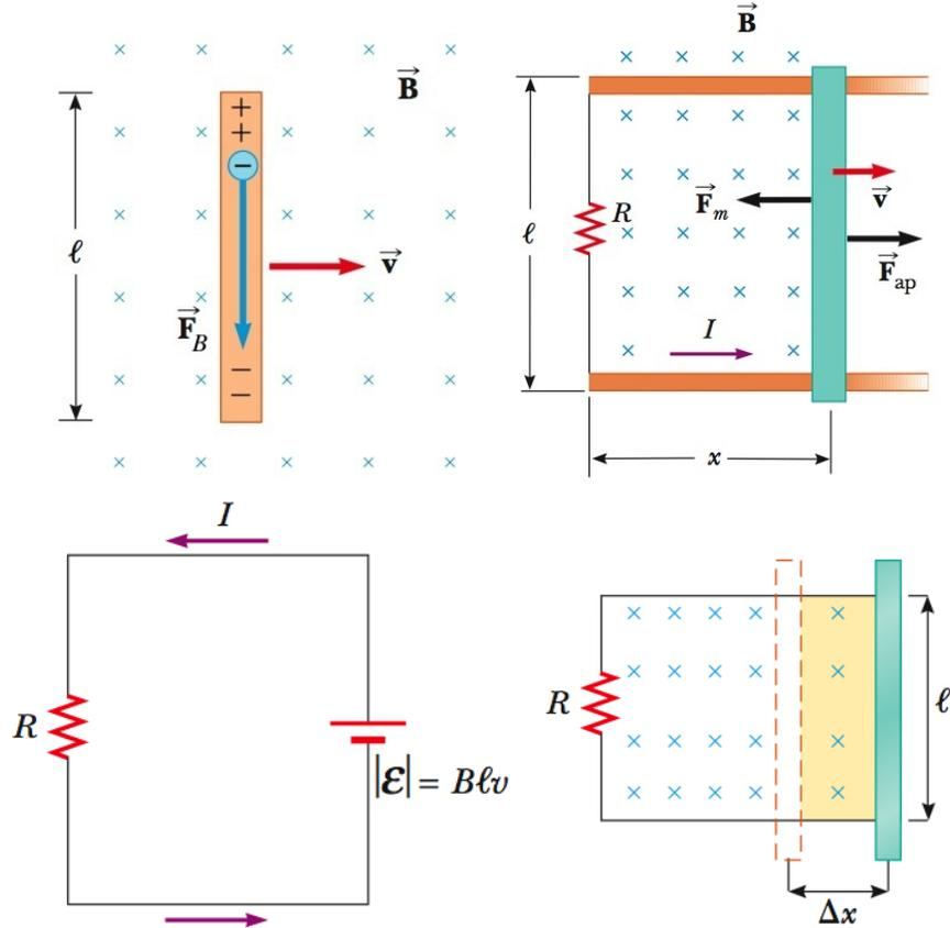
Figura 8.1: Uma barra condutora se move em um circuito fechado. Como as cargas estão confinadas no condutor, a força magnética as move para baixo, como se estivessem na presença de um campo elétrico  $E = vB$ . Verifica-se que a fem associada a  $E$  é igual à variação temporal do fluxo magnético no circuito.
