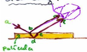
Onda de luz incidente e refletida abc e a onda incidente, transmitida e refletida abdef podem interferir construtivamente dependendo da sua diferença de fase.
