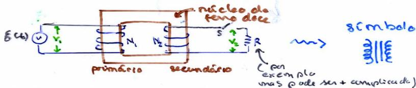
Obs. 1: o objetivo do núcleo de ferro comum aos 2 enrolamentos é aumentar o fluxo magnético e o concentrar de modo que ele passe quase inteiramente de um enrolamento para outro.
