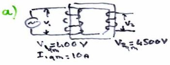
A potência dissipada na linha de transmissão é  $R I_2^2$  com  $R = 30\Omega$  e  $I_2 = I_1 \frac{V_1}{V_2} = 0,89A$  e  $24W$
