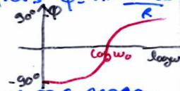
É interessante estudar as voltagens na ressonância.  $\omega = \omega_0 = \frac{1}{\sqrt{LC}} \Leftrightarrow L\omega = \frac{1}{C\omega} \Leftrightarrow X_L = X_C \Leftrightarrow V_L = V_C$ . Como a fase entre L e C é  $180^\circ$  ( $= +90^\circ - (-90^\circ)$ ) temos  $v_L + v_C = 0$  e  $v = v_R$  na ressonância. O circuito se comporta como se não tiver nem L nem C. Assim entendemos melhor porque  $\phi = 0^\circ$ .
