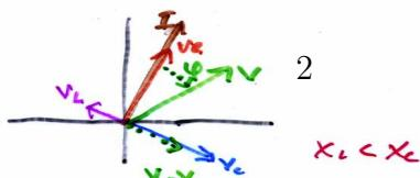
Inicialmente subtraímos o fator para C do fator paralelo, obtemos um fator de módulo  $|V_R - V_C|$  ou  $|V_C - V_L|$ . Como o teorema de Pitágoras:  $V = \sqrt{V_R^2 + (V_L - V_C)^2}$
