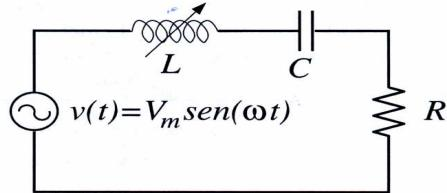
O gerador de corrente alternada fornece uma tensão  $v(t) = V_m \text{sen}(\omega t)$ . A indutância  $L$  é variável e é ajustada de tal forma que a defasagem entre a voltagem do gerador e corrente no circuito é zero. Os valores de  $V_m$ ,  $\omega$ ,  $C$  e  $R$  são conhecidos.
