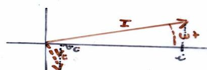
Obs.  $X_C = \frac{1}{\omega C}$  e  $V_c = X_C I \Rightarrow$  se  $\omega \rightarrow 0$ ,  $I \rightarrow 0$ : os capacitores podem ser usados para bloquear frequências baixas. Neste caso, eles agem como filtros "passa-alto".
