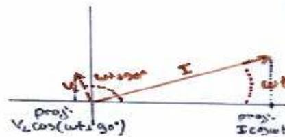
Obs.:  $X_L = \omega L$  e  $V_L = X_L I \Rightarrow$  se  $\omega \rightarrow \infty$ ,  $I = V_L/X_L \rightarrow 0$ : uma voltagem de frequência alta aplicada ao indutor produz uma corrente pequena.
