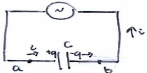
(Não há transporte de carga entre as placas mas como a corrente muda de sentido, elas se carregam e descarregam como se houvesse uma corrente entre elas)
