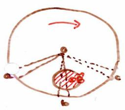
Exemplo: disco metálico girando em um campo magnético  $\vec{B}$  confinado a uma pequena região.
