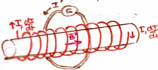
Acima, a corrente  $I$  que varia com o tempo cria um campo magnético  $\vec{B}$  dentro do solenóide, que varia com o tempo. Isto gera uma fem induzida  $\mathcal{E}$  e uma corrente induzida  $I'$  na espira, o que pode ser detectado pelo galvanômetro  $G$ .
