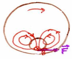
N.B. a interação entre correntes de Foucault e campo magnético produz uma ação que tende a frear o movimento.
